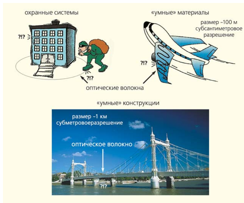
Рис.3. Волоконно-оптические «нервные» системы различных конструкций.
